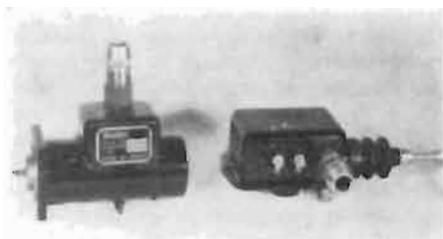
a) Aspetto del complesso elettronico per il comando automatico del cambio di velocità costituito dai due trasduttori qui rappresentati: A sinistra, la dinamo tachimetrica, a destra, il correttore di coppia. Quest'ultimo contiene quattro microinterruttori comandati da un asse azionato dal pedale dell'acceleratore.
